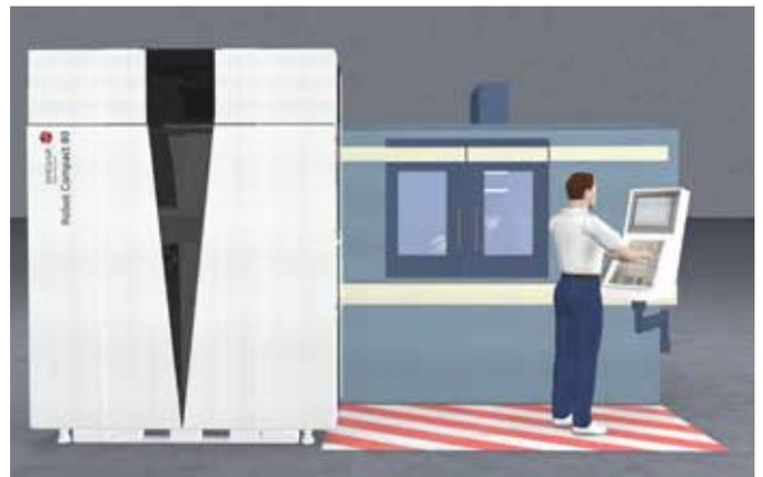
セットアップ、メンテナンス等の手動作業を行う場合、コンパクト 80 を簡単に脇に移動させる事が出来ます。これにより安全に作業出来る領域が確保されます。
