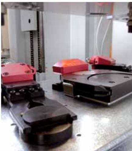
ロボットがパレットサイズに応じて適切なグリッパーを自動的に選択します。グリッパーは専用のステーションに3個まで格納されます。
