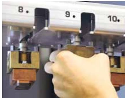
独創的な通過型マガジンの採用により、オペレーター側から電極ホルダーの取り付け、取り出し作業が行えます。
