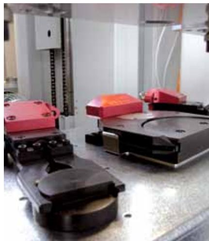
パレットサイズに従って、ロボットコンパクト80は自動でグリッパーを交換します。
