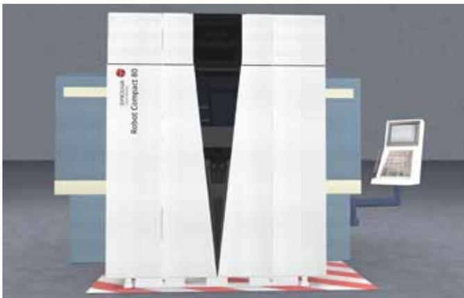
自動モードの時はコンパクト 80 を工作機械の前面に置きます。
