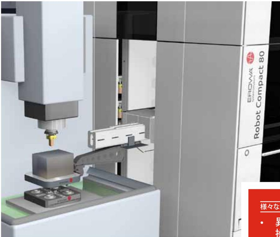
最大 80Kg までの重量がある UPC パレットを工作機械上に正確に搬送することが出来ます。
