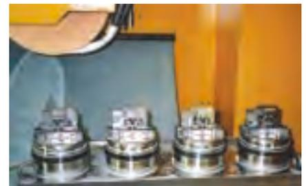
研削加工またはフライス盤加工にエロワパワーチャックは最適です。
