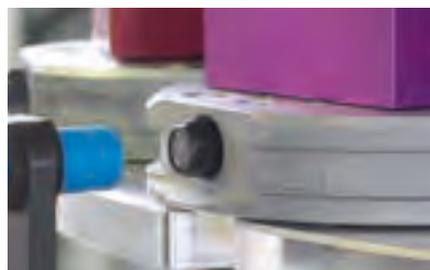
ID チップによる自動パレット検出機能により、各部品が製造工程のどの位置にあるかをいつでも知ることが出来ます。また、ステータスメッセージを SMS 経由で、オペレータに送ることも可能です
