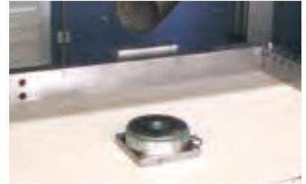
チャックは工作機械テーブルに直接またはアダプタープレートを介して取り付けられます。
