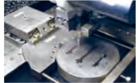
円筒形ワークピース用特殊固定具ユニバーサルホルダーにセットされています。3軸方向の調整が可能です。
