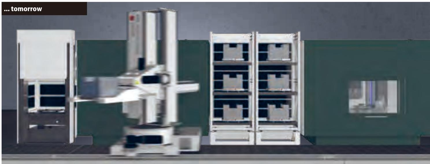
**必要に応じた拡張性** - 機械の追加に対してロボットにはレールと追加ワークピースマガジンを装備します。初期投資は継続使用され、生産ラインの生産能力は倍増し、さらに無人でのシフトが達成されます。
