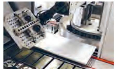
チャックは完全にシールされクーラントやチップの浸入を防ぎます。基準面は自動的にエアで完全にクリーニングされます。
