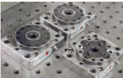
MTSシングルベースプレートはすぐに使用できます。取付孔の間隔が50 mmか63 mmまたはT-スロットの間隔が100 mmの機械テーブルに取付けます。
