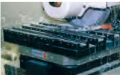
工作機械のテーブル上の UPC はワークピースキャリアーとのインターフェイスとして働き、外段取りされたパレットが瞬時に交換され加工が再開されます。
