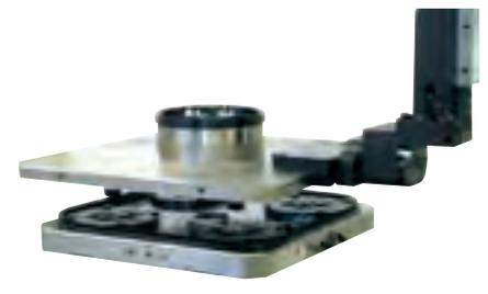
MTSとITSパレットが混在した自動パレット交換操作。この様な混合システムはパーツの大きさに応じた最適なシステムを提供します。
