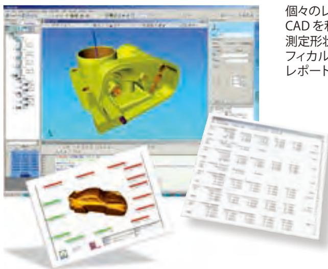
個々のレポートから複雑なレポートまで ARCO-CAD を利用して作成することが出来ます。全ての測定形状は CAD や表、テーブルを利用してグラフィカルに表示されます。個々のテンプレートはレポートの作成を容易にします。
