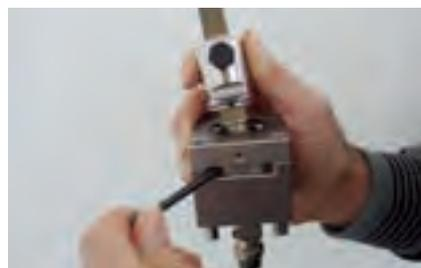
コンパクト電極ホルダーはコンパクトITSアダプターにより通常のエロウ ITS チャックで使用できます。電極ホルダーは素早く、精度良くアダプターにクランプできます。
