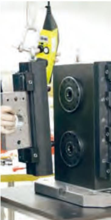
クレバークランプベースレールの両サイドにはアイボルト取付け用のネジ孔があります。
