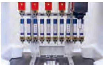
仕様：最大30個のITS 50 / 72 電極。最大ワークピース重量：5 kg (ホルダー含む)
