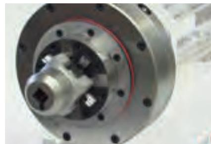
例えば角形電極ホルダーは小型電極や電極ブランクの迅速な交換に使用できます。
