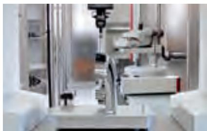
オートメーションキット (オプション) を使用して、CMM Qi はエロワロボットによるワーク供給を可能とします。CNC コントロールは自動品質測定を可能にします
