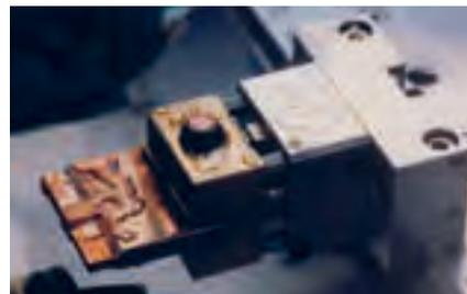
放電加工機の電極ホルダーをワイヤ放電加工機に取り付けることで放電加工の電極製作も素早く、高精度に行われます。
