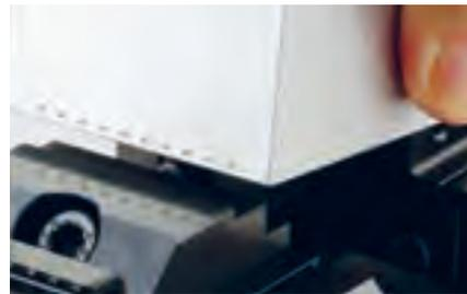
スタンプテクノロジーにより最小3 mmのクランプ高さでワークピースを固定できます。
