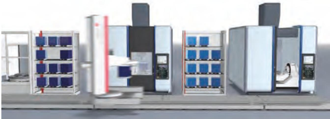
生産セルが拡張され、さらに機械が統合されています。ロボットには、レールや追加マガジン、さらにローディングステーションが付加されています。初期投資は依然として活用し拡張され、しかも現状のプロダクションセルは元の容量の数倍になっています。
