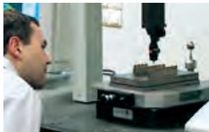
手動、又は CNC のプリセットステーションにより、ワークピースを機械の外でセットアップできます。
