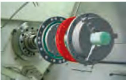
特に旋盤に適しています。プロダクションチャック 210 は中央貫通孔によりワークピースを送り出す事が出来る唯一の精密パレタイジングシステムです。
