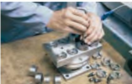
外段取りによりセットアップの大幅短縮
