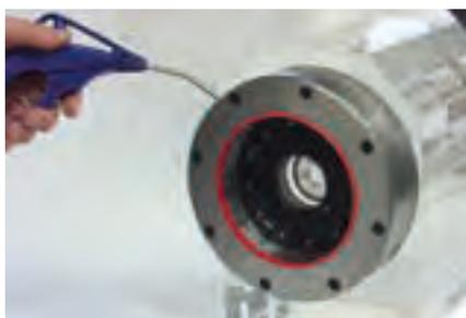
マシンスピンドルに統合されたチャックには圧縮空気をエアガンまたはエア供給装置から送ることでオープンします。
