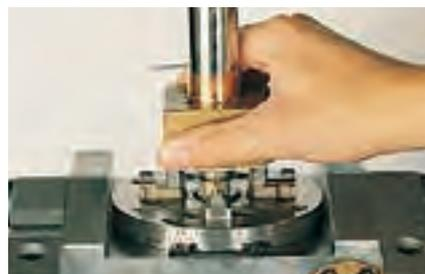
ワークピースは ITS ツーリングシステムの精度機構により、0.002 mm の繰り返し精度でクランプできます。
