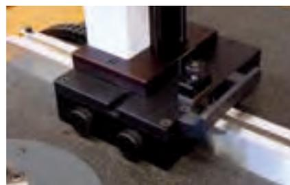
最先端のエアベアリング技術と最適な設定で、ハイトゲージユニットは最小の労力で最大の精度を維持して移動します。
