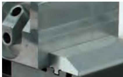
小さくてコンパクトなデザインにもかかわらず、セルフセンタリングバイス 85 P も大きいワークピースを固定するのに最適です。
