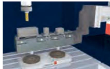
クレバークランプは自動化に対応します。ロボットは、精密且つ敏速にワークピースを機械に運びます。
