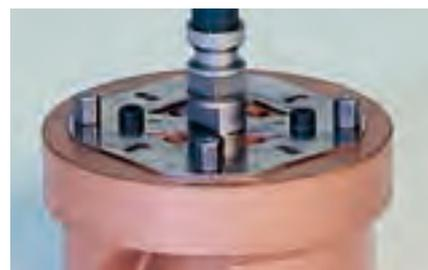
センタリングプレートは、電極またはワークピースにダイレクトに取り付け可能。直ちにITSチャックに装着出来ます。
