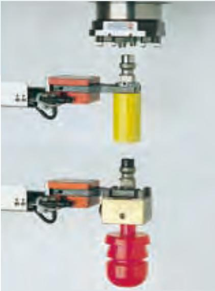
コンビタイプの自動電極交換機ではコンパクト、ITS の両タイプの電極が放電加工機へ搬入が可能です。経済的に自動化が実現できます。
