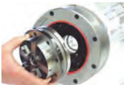
パレット化されたエロワ ITS チャックが取り付けられます。パレットの外周が完全にスピンドルをシールします。
