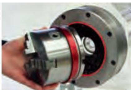
挿入された三爪チャック。芯ブレ、同芯度共に 0.002 mm の繰り返し精度です。
