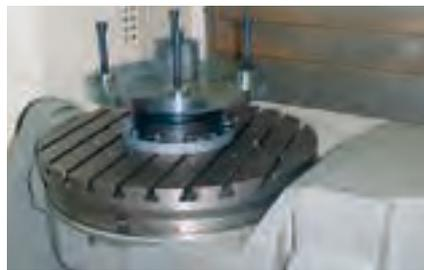
更なる利点:ワークピース、および固定治具を PC 210 パレットに直接取り付けられます。
