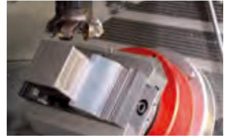
セルフセンタリングバイスは防錆材料で作られています。すべての素材が焼き入れ硬化処理されています。特に、非常に圧力が加わる部品は耐久性を増加させるために表面がコーティングされています。
