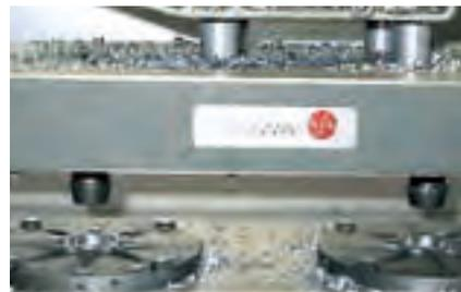
MTSチャックは自動運転が可能です。ワークピース交換中に接触面は自動的に清掃されます。
