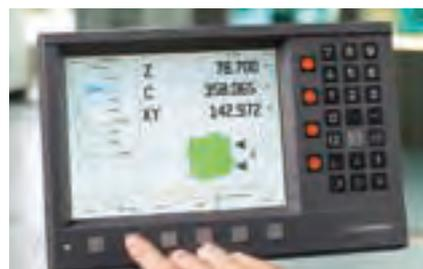
エロワの実用的なユーザーガイダンスがオフセット値を決定するための各測定ステップを逐次表示します。
