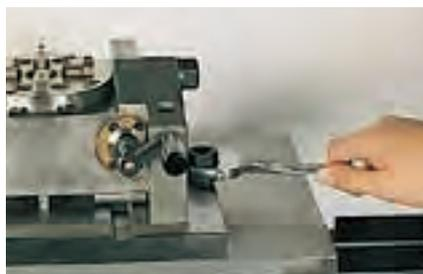
インデックスヘッドは 2 本のボルトで加工テーブルに簡単に固定できます。
