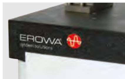
測定定盤は DIN876 / 00 による最高品質天然石で作られています。(認証及び測定記録付き)
