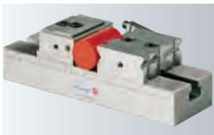
ベース 220、クランプセットスライド及びプリズマブロックにより縦、横両方向で多様な円筒形ワークピースをクランプ出来ます。
