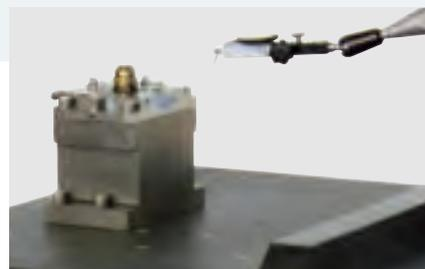
クランプシステムを選択します(ここではパレットセット W)。プリセットステーションはモジュラー設計になっています。必要なクランプシステムを選択します。
