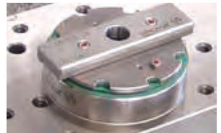
全ての軸、X、Y、Z およびセンターは小さなアライメントパレットで検査されます。
