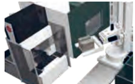
**03** | 品質管理の組み込み。プロセスラインに組み込まれた EROWA CMM Qi 測定装置がこの要求を達成します。
