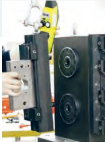
ミネラルキャストキューブに組み込まれたMTSチャックとエロワクレーバークランプツーリングシステムとの組み合わせはとても有効な生産方法です。
