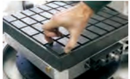
チャックとパレット間の中継ダクトによりワークピースは空圧、油圧または真空によりクランプする事も出来ます。
