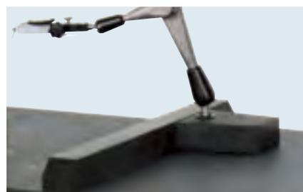
フレキシブルなベースの上でダイヤルインジケータを使用して、ワークピースのZ平面内の調整またはストッパーガイドレールに沿ってY軸の調整を行います。
