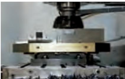
低背デザインにより十分なワークピース加工エリアが確保できます。
