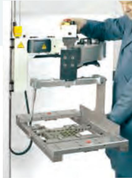
エロフリフトを使用して簡単安全にフレームを機械へ搬送出来ます。
