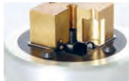
高い安全性、エロワ ITS 50ホルダーCのシーリングプレートとシールリングは完全密閉を構成します。これによりチャックは汚染物の浸入を最大限防ぎます。
