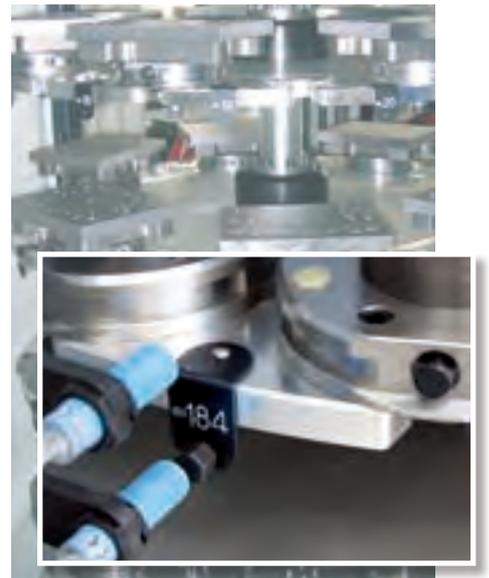
EWIS™ ラピッド IDシステムは概ねホルダーとパレットに取り付けられます。最新のデータキャリアチップで全てのパレットがいつでも識別されます。ハンドリング装置はマガジンの負荷を自動で調査します。
