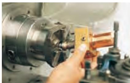
外段取りされたパーツを機械にローディングすれば生産効率は増加します。
