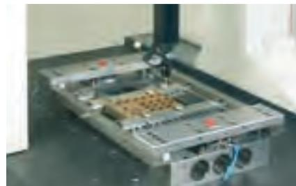
機械が加工中に、エロフプリセットステーションで次の仕事が素早く精度良くプリセットされます。外段取りにより機械の稼働率が飛躍的に向上します。
